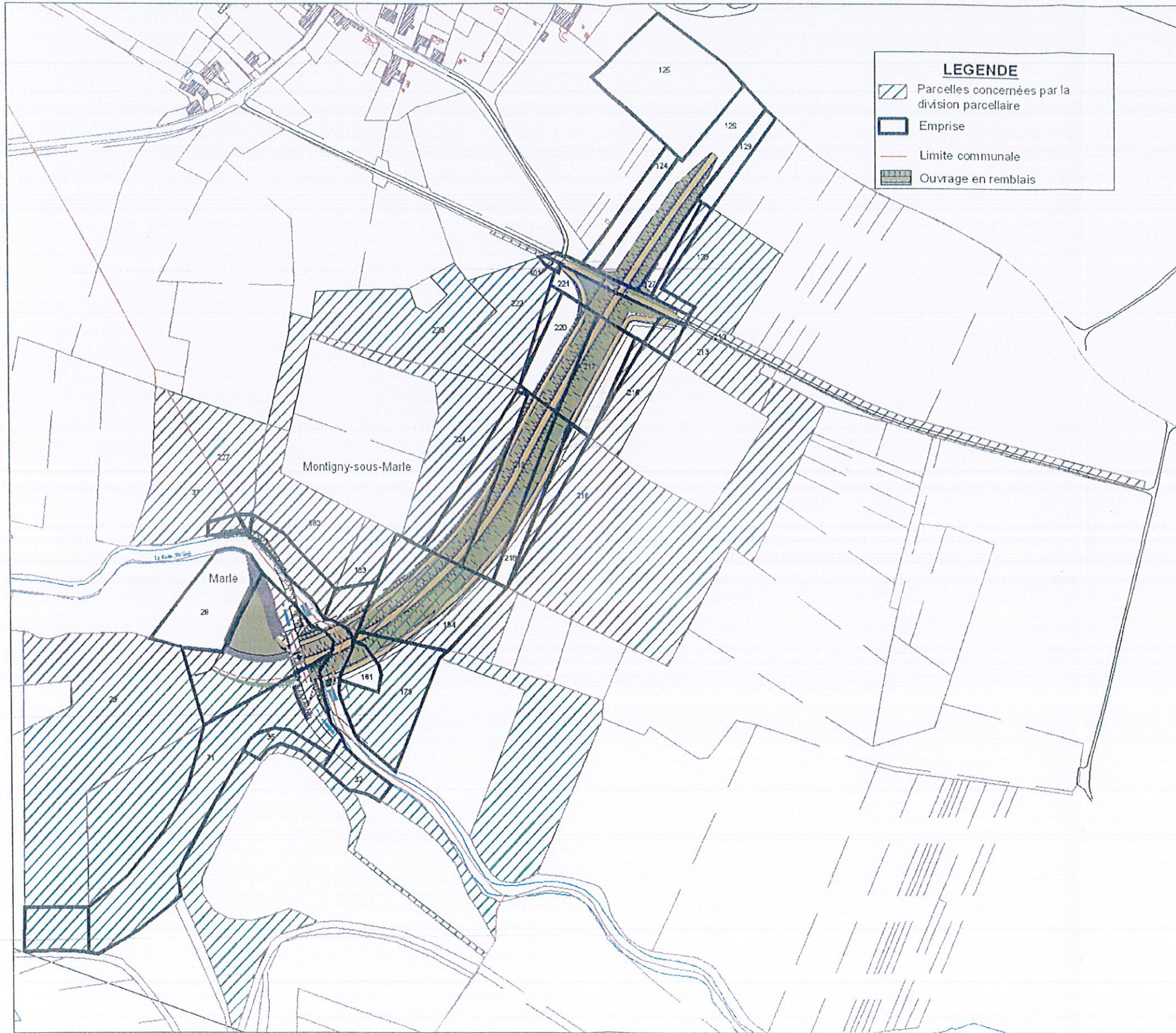
Figure 1 : Plan parcellaire au niveau de l'emprise de la digue sur les communes de Montigny-sous-Marle et Marle
