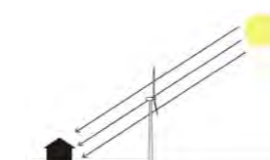
Source : MEEDDM, 2010 Figure 154 du phénomène de battement d'ombre
