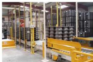
Zone d'accrochage des roues "brutes" sur support vertical (Balances sur convoyeur aérien)
