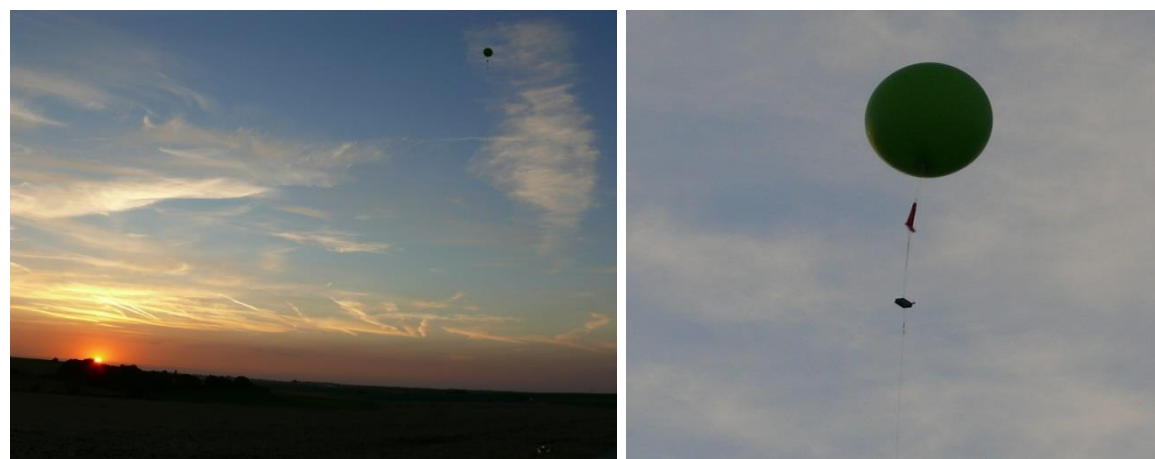
Figure 175 : Ballon captif gonflé, avec micro et ancré au sol (source : AUDDICE Environnement, 2018)
