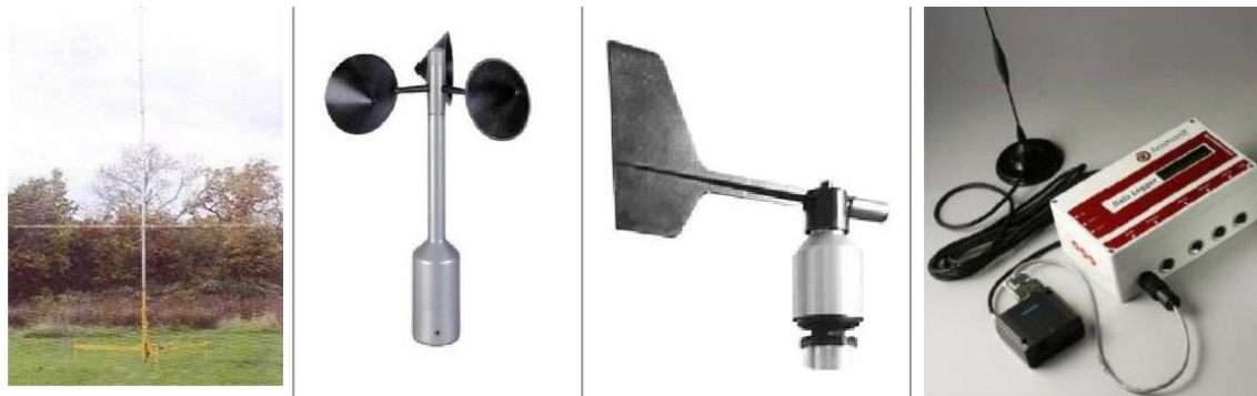
Figure 170 : Appareillage d'enregistrement météorologique pour les mesures acoustiques (source : VENATHEC, 2018)
