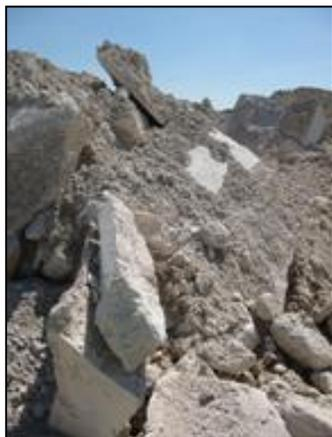
La société HOLCIM a développé le recyclage des bétons de centrale et de démolition sur son site du Plessis-Belleville (Oise). Les bétons et déblais de démolition sont d'abord stockés avant d'être concassés afin de produire des matériaux recyclés. Le tonnage ainsi produit de matériaux recyclés est d'environ 16 000 tonnes par an, et sera amené à augmenter dans les prochaines années.
