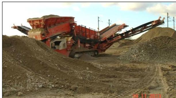
Campagne de concassage mobile des bétons de recyclage (Plessis-Belleville - 2013) : à g., concasseur ; à dr., crible.
