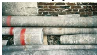
Canalisation en amiante-ciment
