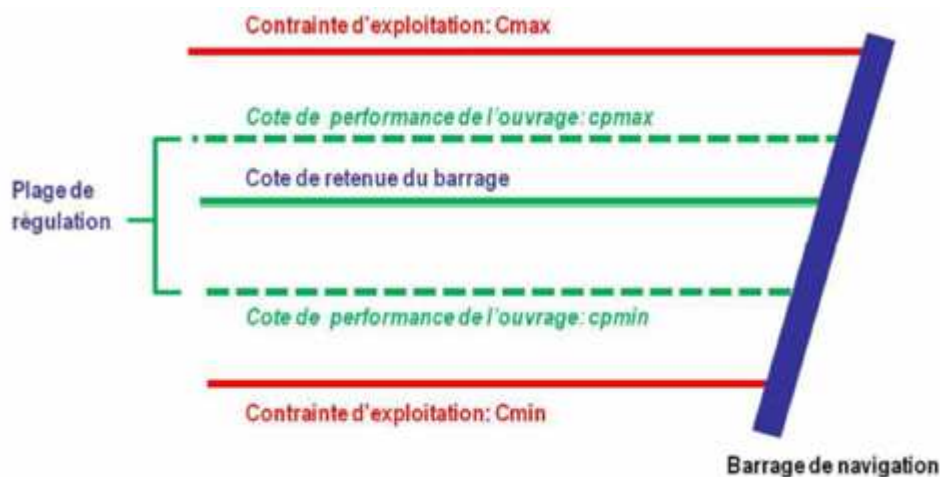
Figure 6 : Cotes d'exploitation des ouvrages
