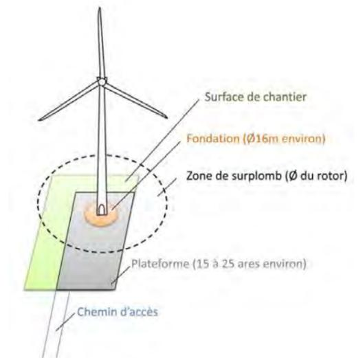
Figure 9 du schéma de principe des emprises au sol d'une éolienne
