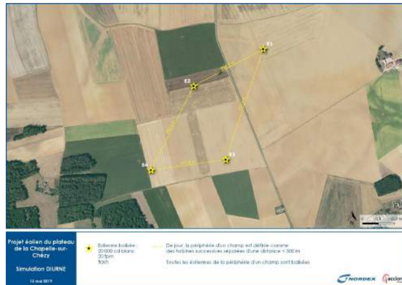
Carte 111 : Balisage lumineux de jour du projet éolien du Plateau de La Chapelle-sur-Chézy (Nordex, 2019)
