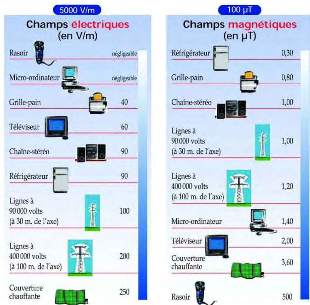
Figure 44 : Exemples de valeurs de champs électriques et magnétiques (Source : RTE)
