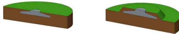
Figure 2 : schéma d'une fondation enterrée au niveau du sol naturel (à gauche) et surélevée du terrain (à droite)
