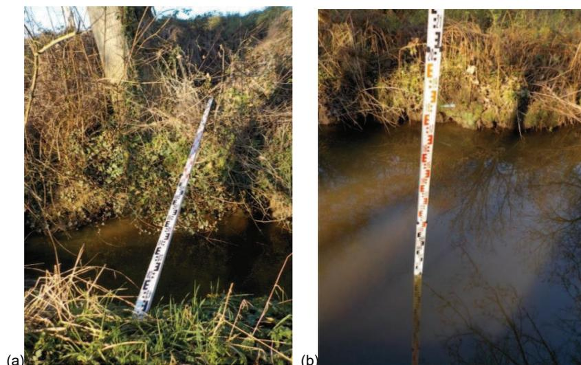
Figure 3-6 : Mesures de la largeur pleins bords (a) et de la hauteur d'eau (b)
