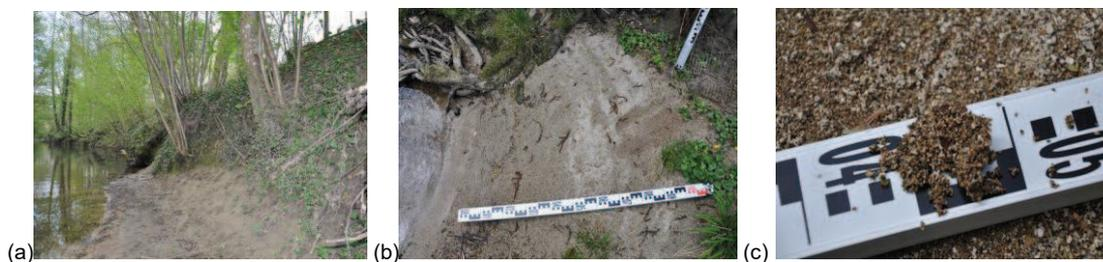
Figure 3-7 : Exemple de recueil qualitatif, au droit des profils, de la nature des berges (a), des dépôts (b) et du charriage de fond (c)
