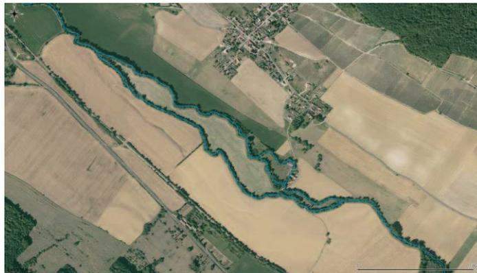
Figure 3-2 : Exemple de digitalisation du lit mineur à l'aide des orthophotographies montées sous un SIG
