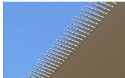
*Photographies de pale dotée d'un système TES (peigne / dentelure)*
