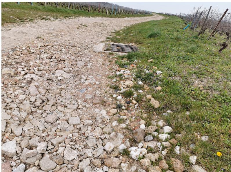
**L'emplacement du bac dépierréur en bordure du chemin n'est pas d'une utilité probante à cet endroit.**
