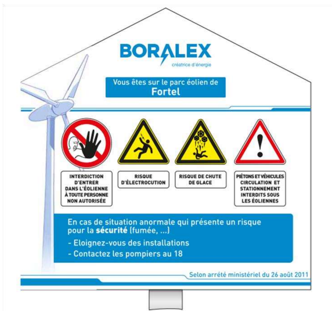
Figure 2: Panneau type d'avertissement à l'entrée des plateformes des éoliennes (exemple)
