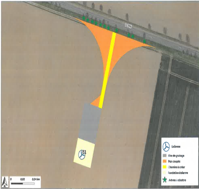
a : éolienne (E1)
