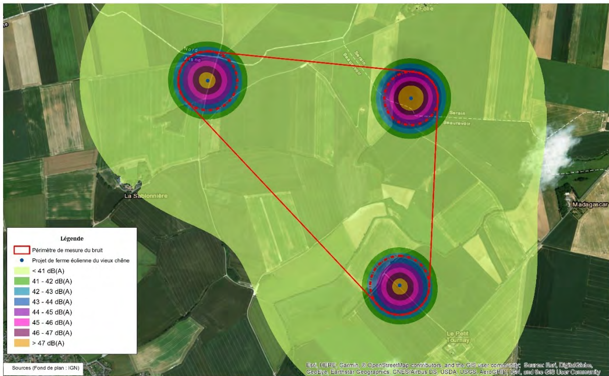
Isophones au périmètre de mesure du bruit de l'installation – Configuration N117
