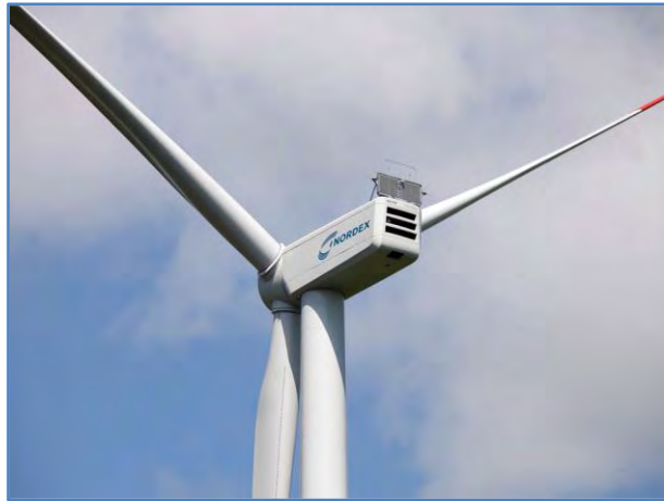
Figure 8 : Photographie de la nacelle de la N117-3,6M W
