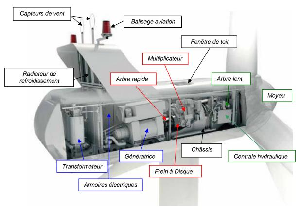
Figure 6: Composants d'une nacelle
