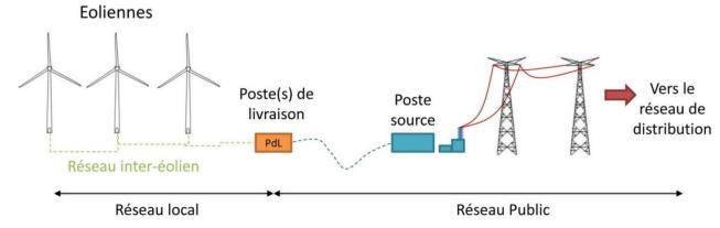
Figure 8 : Raccordement électrique des installations (source : INERIS/SER/FEE, 2012)
