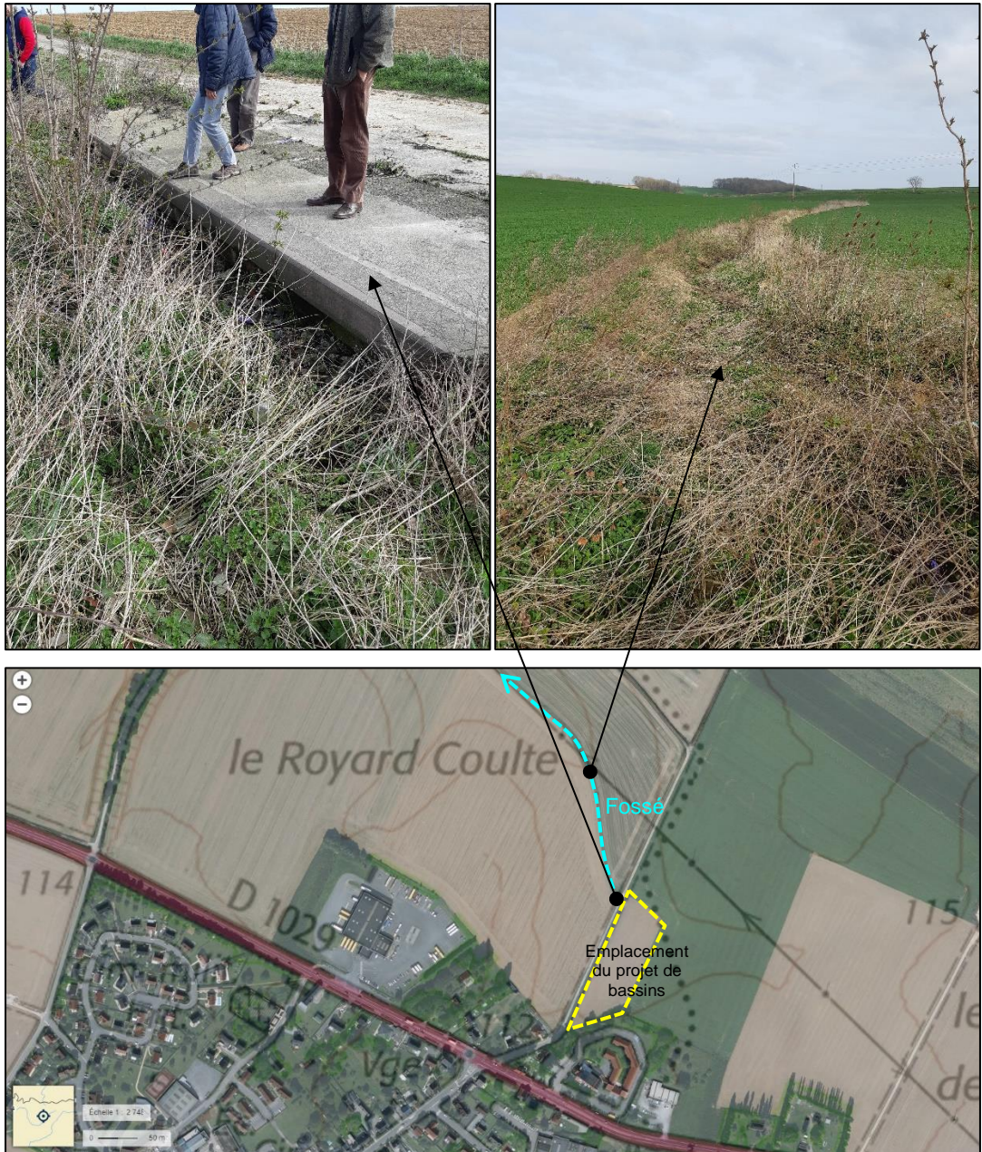
Document n° 49 : Photographies du fossé exutoire de la surverse du projet de bassins
