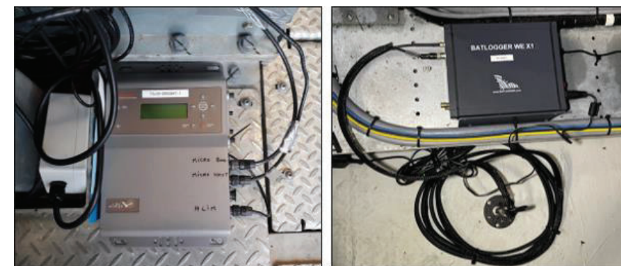
Photo 3 : Illustration d'un SM3BAT (à gauche) et d'un Batlogger (à droite) installés dans les éoliennes
