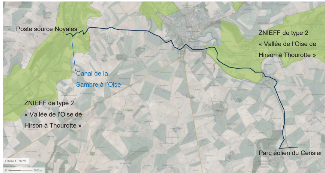
Figure 22 : Raccordement hypothétique entre le parc éolien des Cerisiers et le poste source Noyales
